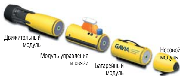
Модульность конструкции АНПА GAVIA
